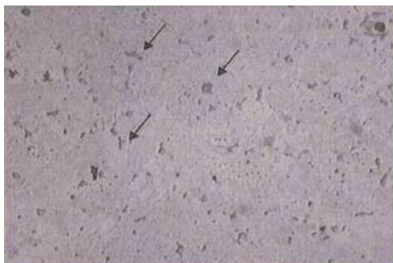
炭化クロムと炭化モリブテンを示す顕微鏡写真で、ムラカミ試薬でエッチングしたもの（元々は 1,000 倍）
